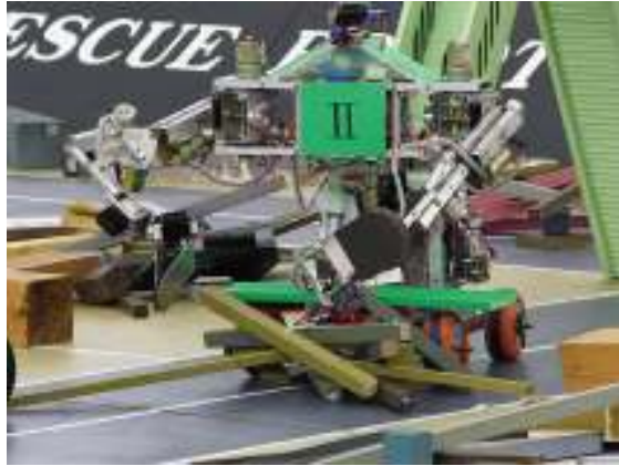
瓦礫を除去する 2 号機 上半身の動きを右の写真のマスターで操作
